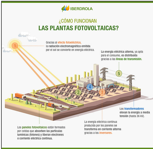
Figura 1: Funcionamiento de las plantas fotovoltaicas Tomado de: IBERDROLA (S/n).
