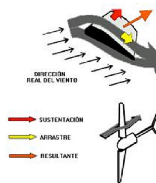
Figura 2: Fuerzas de sustentación y arrastre Tomado de: Luque, M. (2017).
