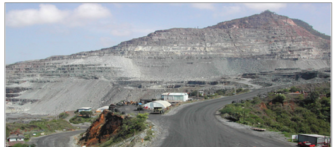
Figura 10. Vista panorámica del yacimiento de Peña Colorada. La secuencia vulcanosedimentaria tiene una disposición subhorizontal. Diques subverticales, de composición andesítica a dacítica, cortan a todas las rocas de la columna, incluyendo a los cuerpos de mineral.
