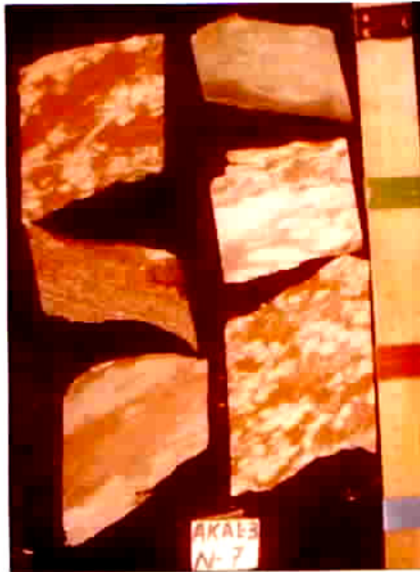
Fig. 24. Muestras de núcleo del pozo Akal-3, donde se observan limos rojos y anhidritas nodulares propios de un ambiente de supramarea con influencia continental. Pozo Akal3, Núcleo 7.
