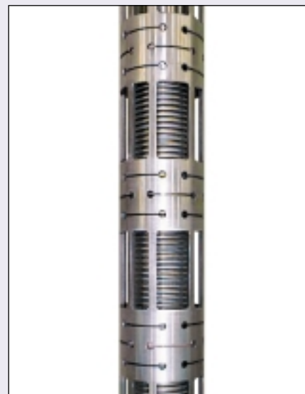
^ Una sonda de adquisición de registros sísmicos con ranuras para retardar los arribos propios de la herramienta.
