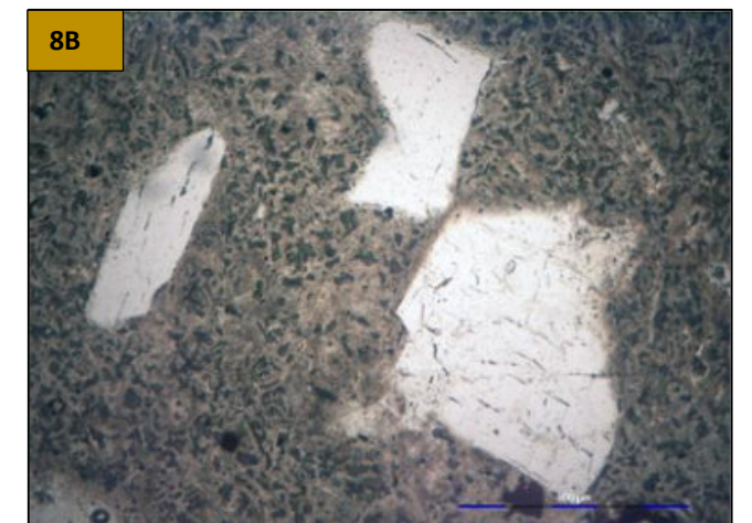
Foto 8: Fragmentos líticos de rocas piroclásticas con textura piroclástica - vitroclástica y microfragmentos (shards) de vidrio, ver elipse amarilla en nicoles paralelos (muestra C01-B).
