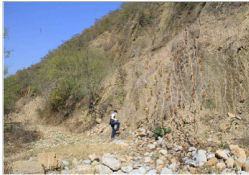
Foto B. Medición de rumbos y echados en un afloramiento de la Formación Méndez. Pasante de ingeniero geólogo Luis Arista.
