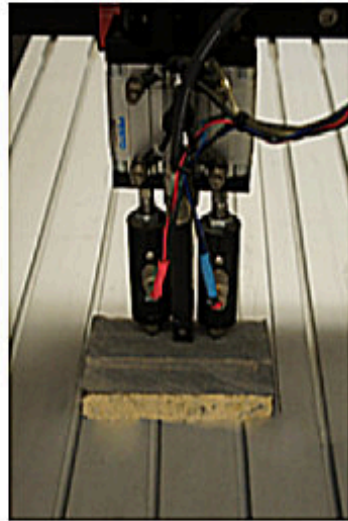
Figura 4. Se muestra un escáner que mide la rapidez con la que viajan las ondas acústicas en la superficie de una muestra de roca.
