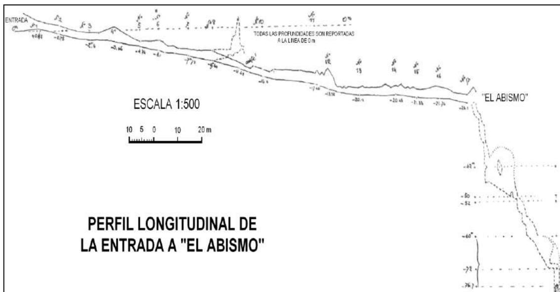
Figura 11: Perfil longitudinal de la cueva de Balme hasta el área de "El abismo", reflejando una clara profundización como lo señala Miranda en sus descripciones. El desnivel con respecto a la entrada de la cavidad es de 26,1 m y con respecto al fondo del abismo de 76,7 m. Entre ambos puntos se tiene un desnivel de 50,6 m. Modificado de Pittard y de Joly (1972).
