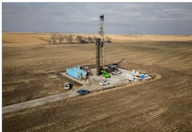
Perforación para hidrógeno (pozo Hoarty N3) de la empresa Hyterra cerca de Geneva City en Nebraska (EE. UU.). Hyterra.
