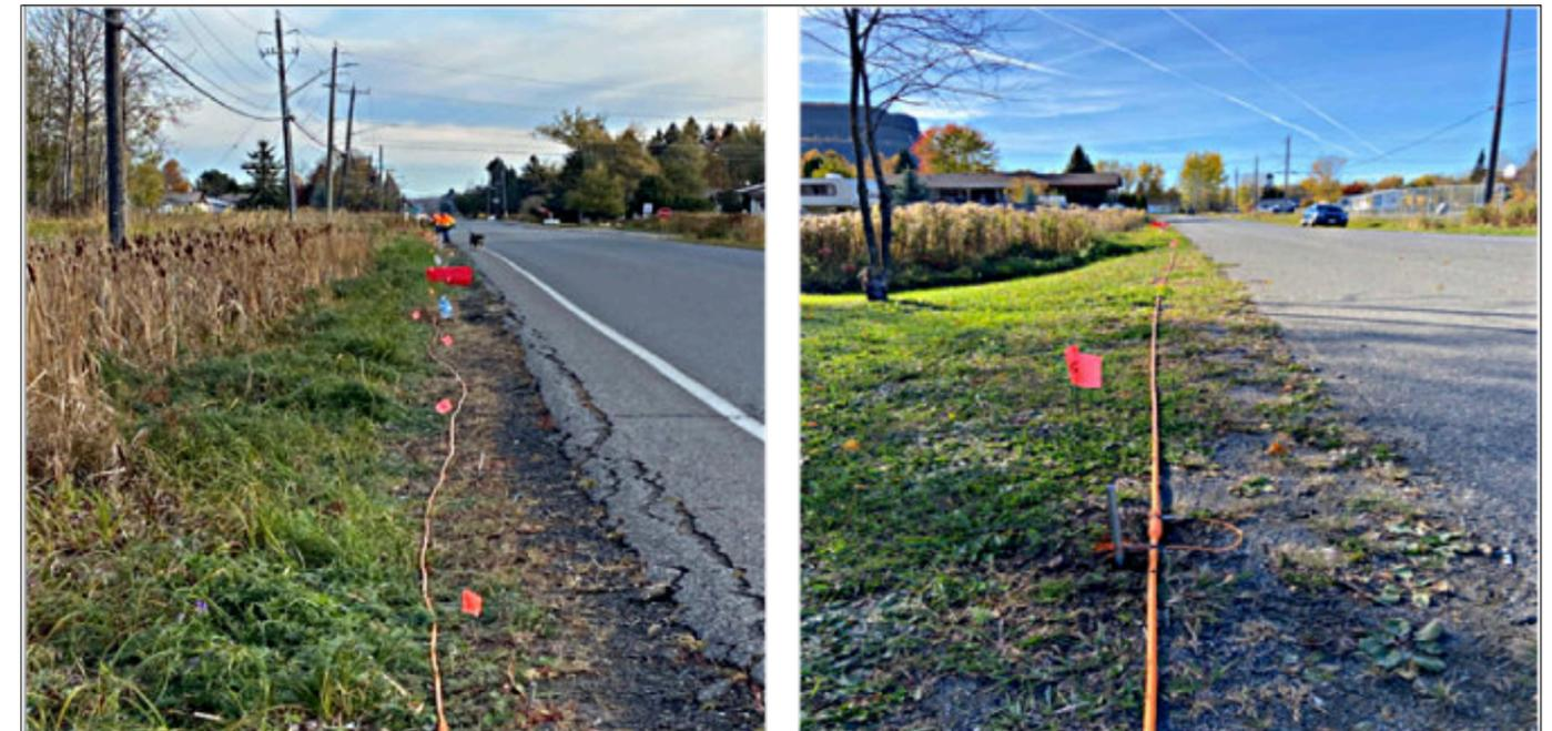
Figura 4: Cable de 400 metros del tendido eléctrico. Junto a la banderola se puede apreciar el electrodo clavado en el suelo que se conecta cada 5 metros
