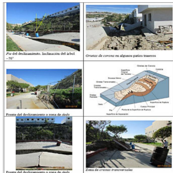
Figura 9. Identificación de las diferentes partes del deslizamiento rotacional entre el fraccionamiento Valle del Sur y la planta BBS de acuerdo con el modelo de Highland y Bobrowsky (2008). Los nombres en itálicas se refieren a los nombres del modelo de deslizamiento.
