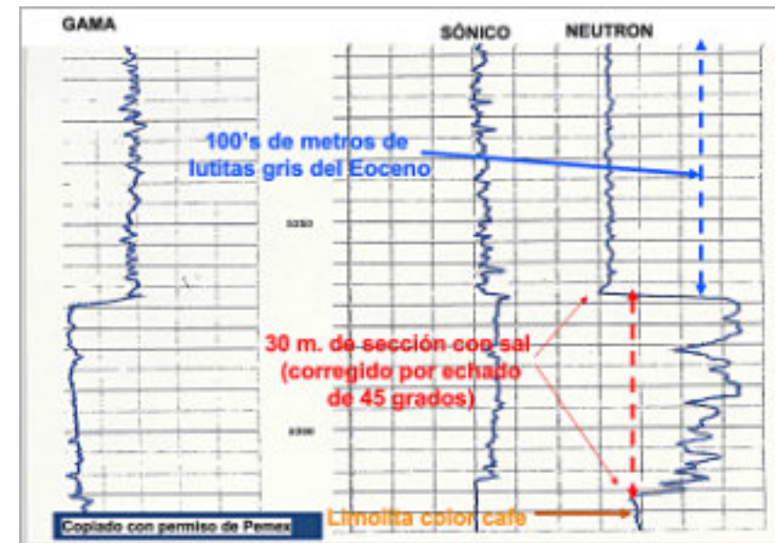
Figura 7. Segmentos profundos de los registros gama, sónico y neutron del pozo Mataespino 101-B.
