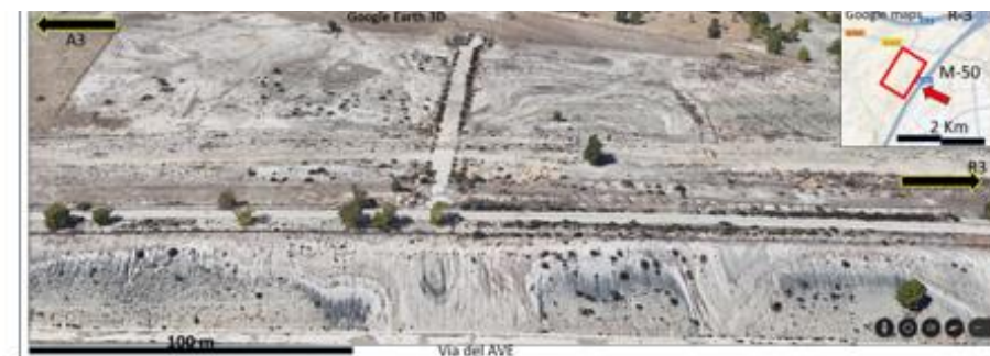
FIGURA 5. Deformaciones tipo "soft-sediment" (Giraldo Ceballos, 2013) en capas miocenas (entre autopistas A-3 y R-3). El talud sub-vertical corresponde a la vía del AVE. Observe las trazas de las capas en el terreno (Fig. 6 para detalles de la vista en planta).
