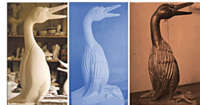
Figura 4. Proceso simplificado de confección de gárgola representativa de ave: moldeado en yeso, labrado sobre molde de yeso, y molde cobreado (fuente: Mariano Rómulo/Infocielo)
