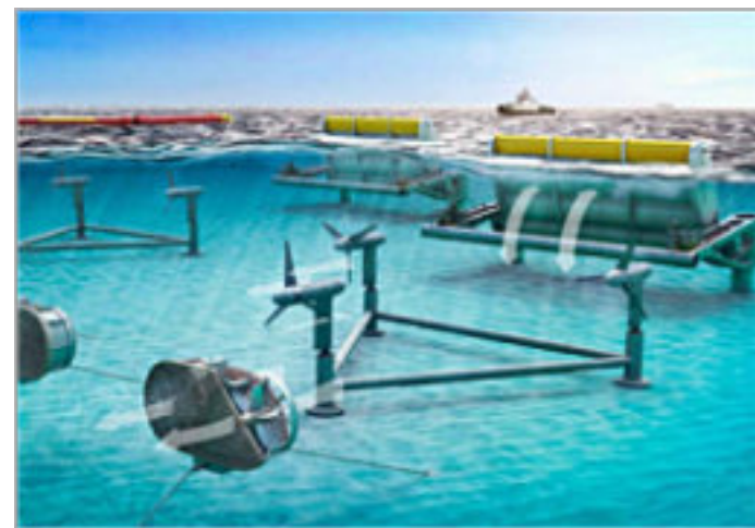
Ejemplo de dispositivos y tecnología usada para aprovechar la energía oceánica.
