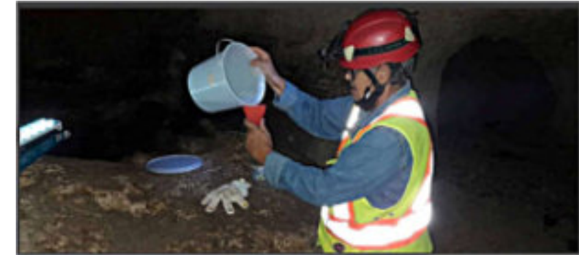
Fig. 7. Muestreo de aguas subterráneas en la Cueva del Jaguey, polígono experimental para el estudio del transporte de nitratos en el epikarst, la zona no saturada y el acuífero (Foto del autor).
