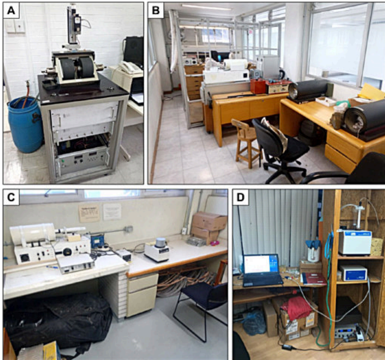
Figura 4. Instrumentos del Laboratorio de Paleomagnetismo en Ciudad Universitaria. (A) Micromag Princeton Measurements. (B) Vista general de uno de los espacios del LP-CU en el que se observa el blindaje magnético tipo Helmholtz (jaula plateada), blindajes magnéticos de metal Mu (cilindros negros), hornos de desmagnetización (cajas plateadas), desmagnetizador de campos alternos (instrumento con forma de caja con cilindro blancos), entre otros instrumentos. (C) Desmagnetizador de campos alternos con campo directo (para medición de magnetización remanente anhisterética) y un magnetómetro de giro JR6. (D) Susceptibilímetro de puente MFK-FA con todos sus módulos de operación.
