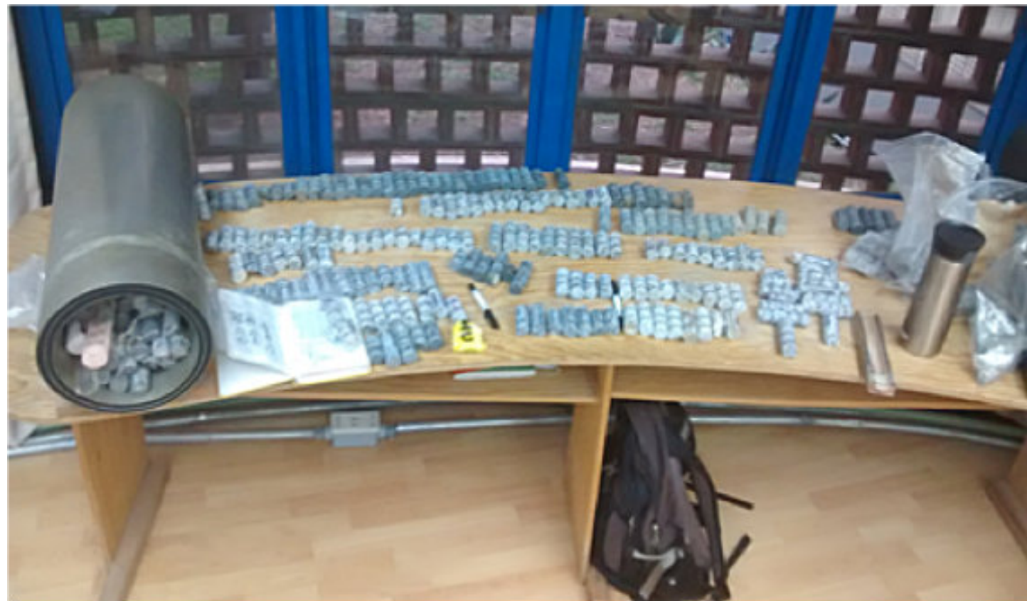
Figura 3. Preparación de muestras, núcleos perforados, en el LP-CU antes de ser analizadas en los equipos de paleomagnetismo.
