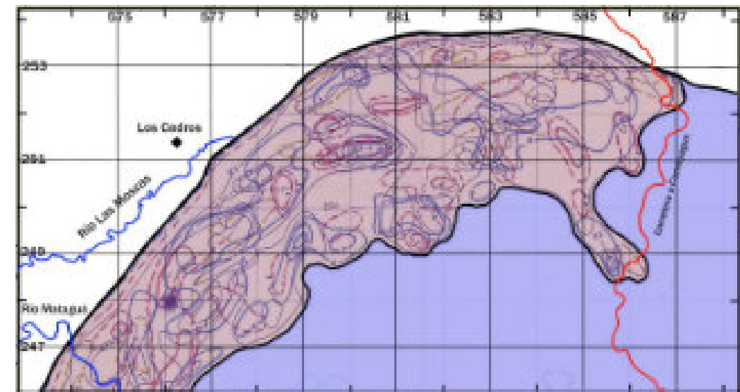
Figura.2. Fragmento del mapa aeroradiométrico (Liubil y Martinova, 1981), U(Ra)-Th-K, del NW de la Cúpula de Trinidad Expedición Escambray II (según Lledías, 1986). Obsérvese la orientación de los ejes de anomalías, paralelos a los rumbos NW-NE (fallas) y EW, correspondientes a contactos entre nappes y cuerpos litológicos.
