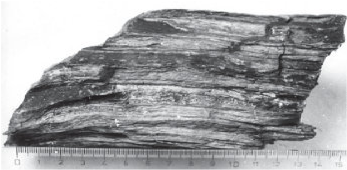
Figura.135. Ritmos de capas blanquecinas de metasilicita (metachert) y esquistos metapelíticos micáceos, graffíticos intercalados. Roca típica de la Formación La Sabina. Al norte de Crucecitas en el terraplén hacia La Carlota. Cúpula de Trinidad. (Foto: Duchan Dostal; 1983 sobre una muestra de Álvarez-Sánchez de 1981).
