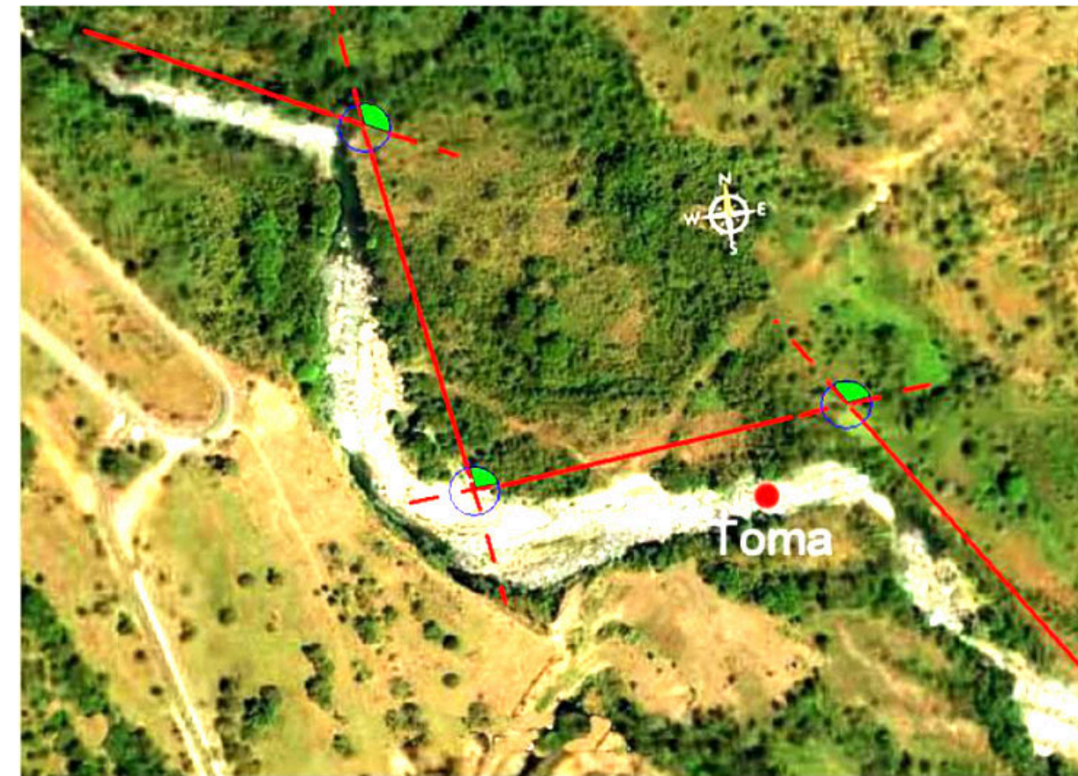
Figura.11. Meandros acodados del Río Caldera causados por fallas conjugadas con una alta probabilidad. Nótese los bruscos cambios y la rectitud de las riberas a pesar de la uniformidad litológica y la caída de la carga fluvial a continuación del primer tramo (Foto de Google Earth) (Interpretación propia, 2008a).
