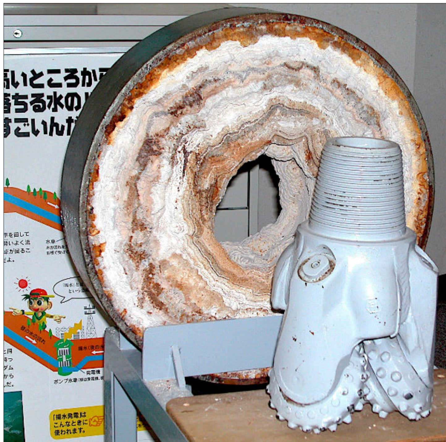
sección cortada de una pipe de explotación de la central geotérmica de Hatchobaru, en Oita (Kyushu, Japón). La pipe está cementada por sílice precipitada durante la generación de vapor para la planta. Es la central geotérmica más grande del país con 112 MW. Foto de Jordi Tritlla Cambra .
