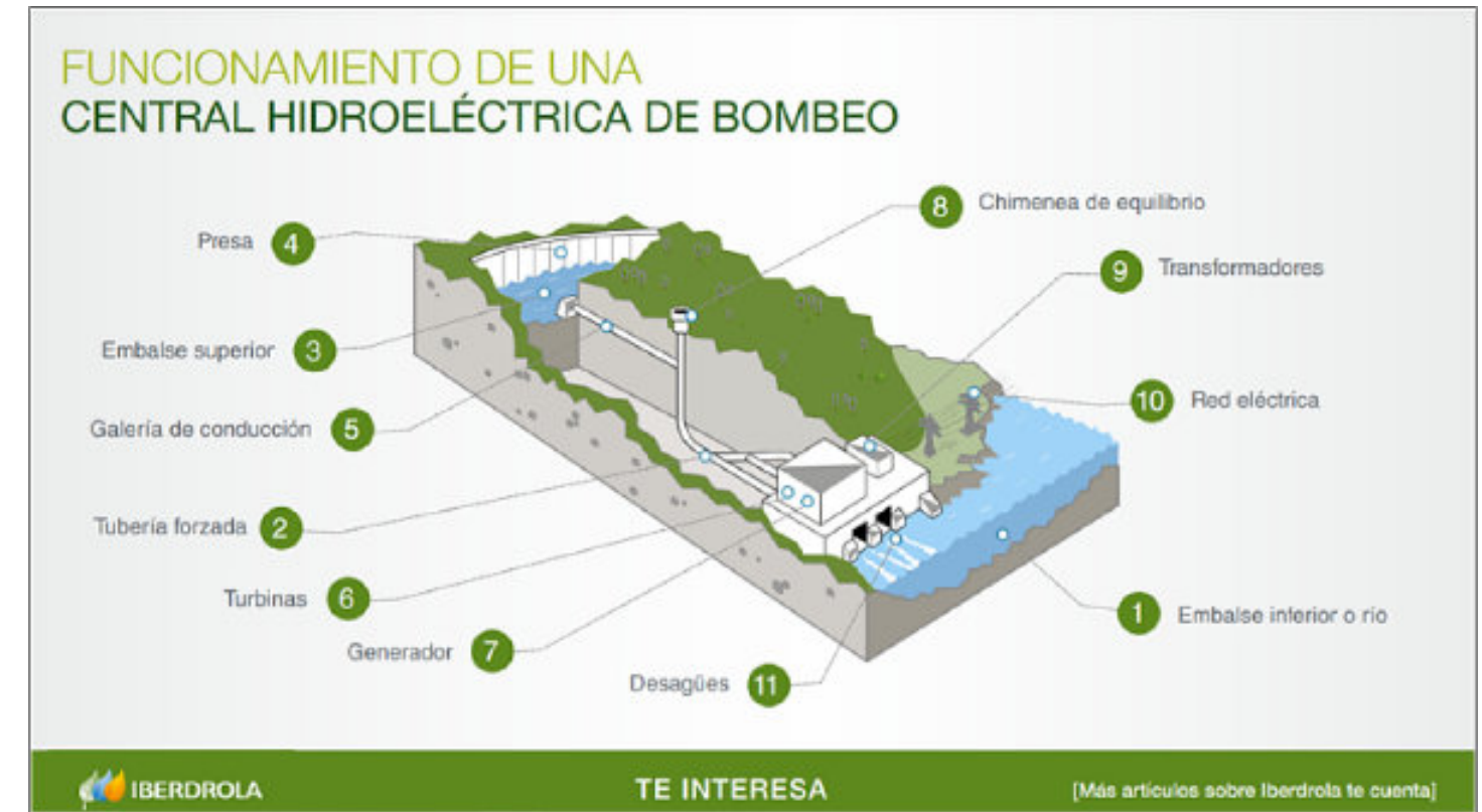
Figura 3: Central hidroeléctrica de bombeo Tomada de: IBERDROLA.
