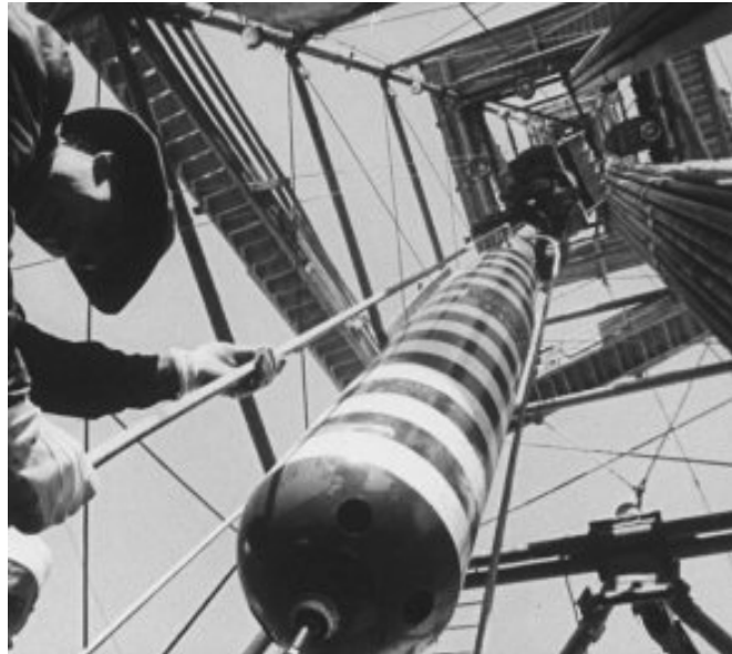
Figura 3. Bajando la bomba nuclear en el pozo desviado.
