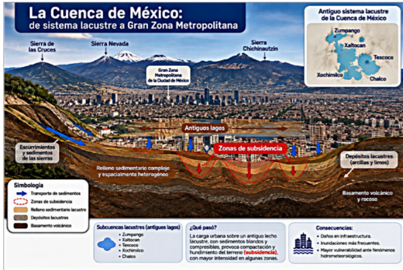
Figura 2. La Cuenca de México: del antiguo sistema lacustre a la Gran Zona Metropolitana. Representación esquemática de la Gran Zona Metropolitana asentada sobre el antiguo sistema lacustre de la Cuenca de México y su relleno sedimentario heterogéneo. Se muestran de manera conceptual las antiguas subcuencas lacustres, el aporte de sedimentos desde las sierras circundantes, los depósitos lacustres y la ocurrencia diferencial de subsidencia en sectores de la cuenca. La representación no está a escala y las zonas de subsidencia son ilustrativas. Fuente: elaboración propia
